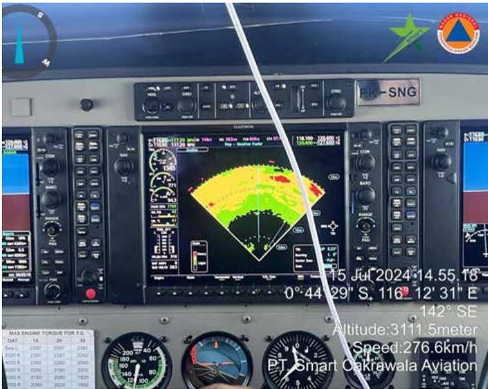
Gambar 15.8 Tampilan radar cuaca dari pesawat Cessna
