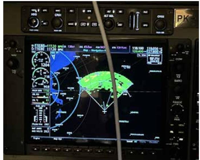
Gambar 15.10 Tampilan radar cuaca dari pesawat Cessna
